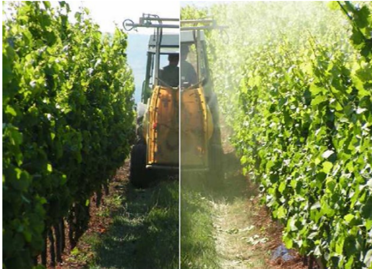
Vergleich: Injektordüse links, Standard Hohlkegeldüse rechts
