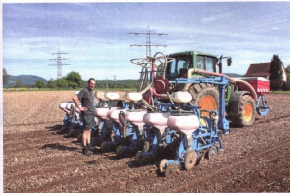
Maissäegerät mit der Möglichkeit der Mikrogranulat- und Unterfußdüngung. Der Dünger wird unmittelbar neben dem Saatkorn abgelegt und steht dem Saatkorn direkt zur Verfügung. Fotos: Sprich
